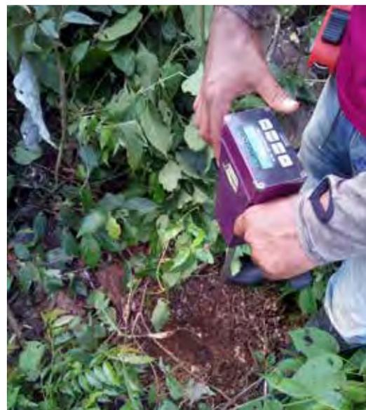
**Figura 15.** Medición de la compactación del suelo mediante el uso de penetrómetro
